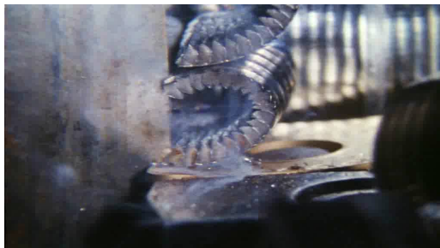
Типичное стружкообразование — съёмка высокоскоростной камерой
